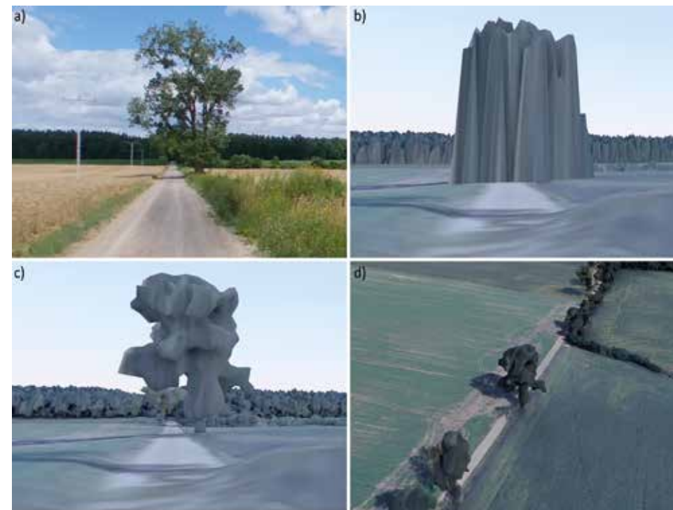
Ryc. 4. Różnica pomiędzy reprezentacją 2,5D a 3D drzewa, a) fotografia referencyjna drzewa, b) model 2,5D, c) model 3D, d) wizualizacja 3D
